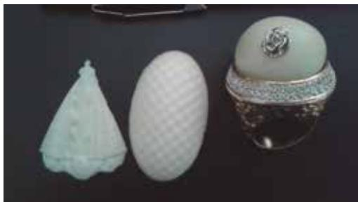
Figura 4. Jarinas esculpidas na máquina CNC prontas para compor joias.
